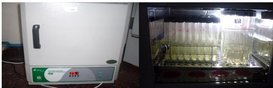
Figura 15 - Estufa bacteriológica A. Tubos de ensaio com Colilert B.
